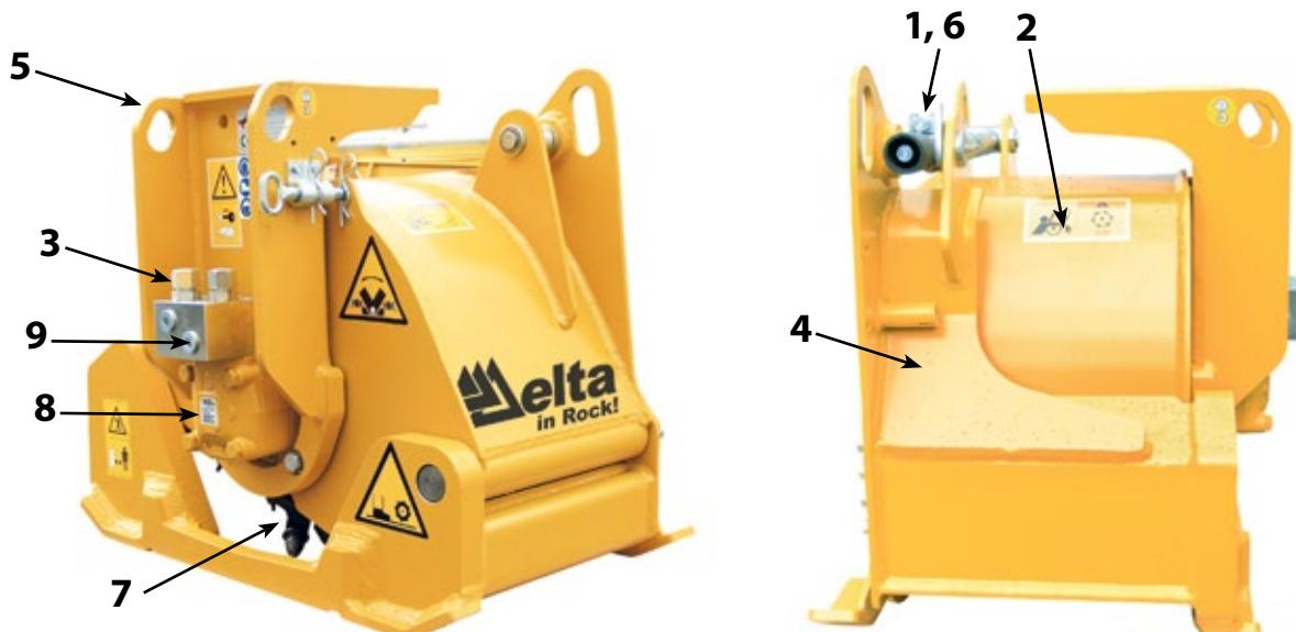
1. Фиксатор регулировки глубины
